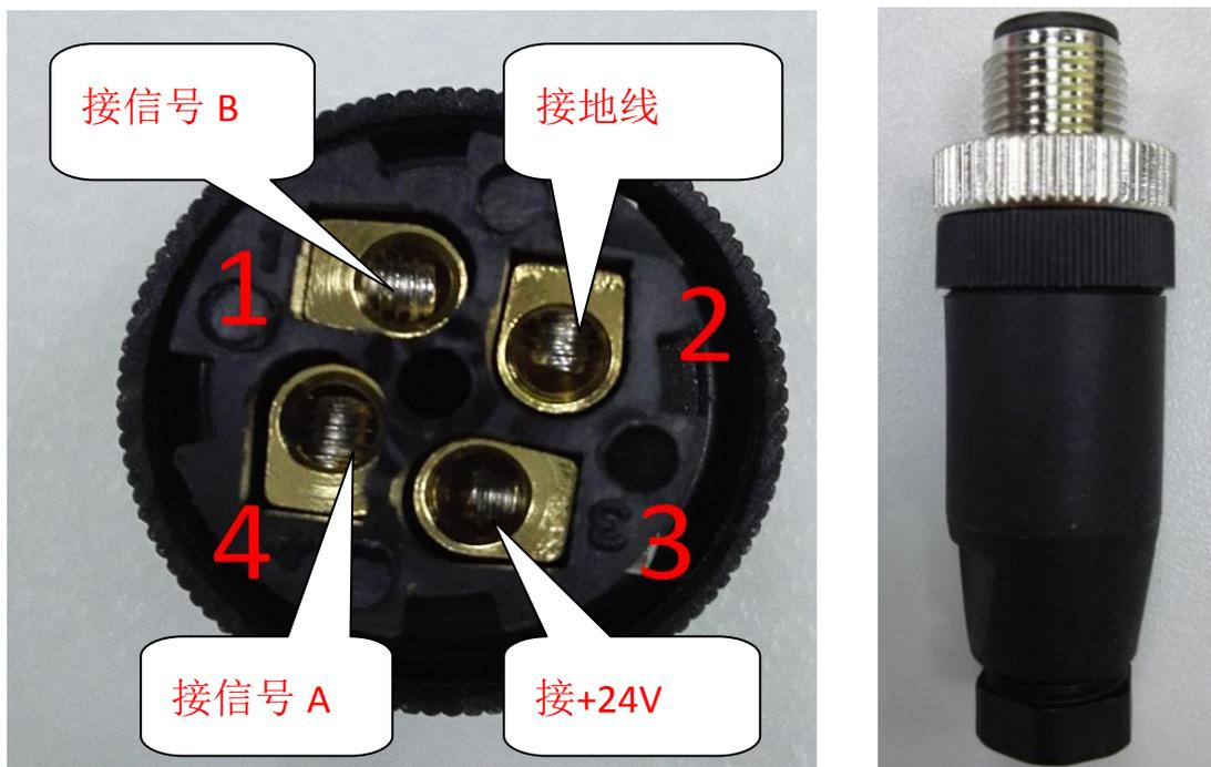
图 10 同步器的连线图
