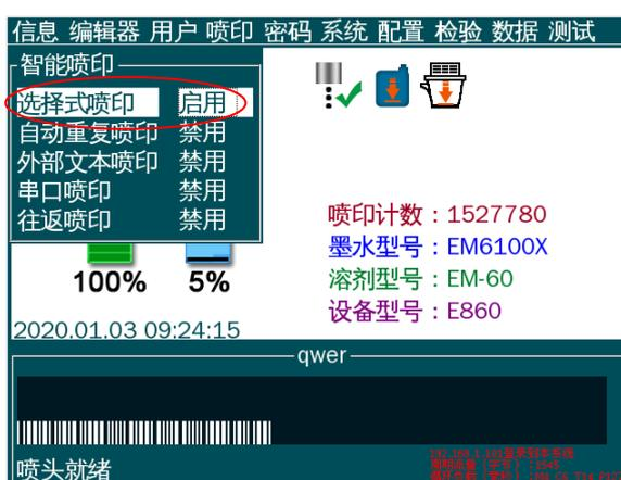
(2) 将会出现提示：请选择光电眼 1 或者光电眼 2 被交互触发时将喷印的信息！按【Enter】键或【Esc】继续操作。弹出对话框选择喷印信息字样，按【
