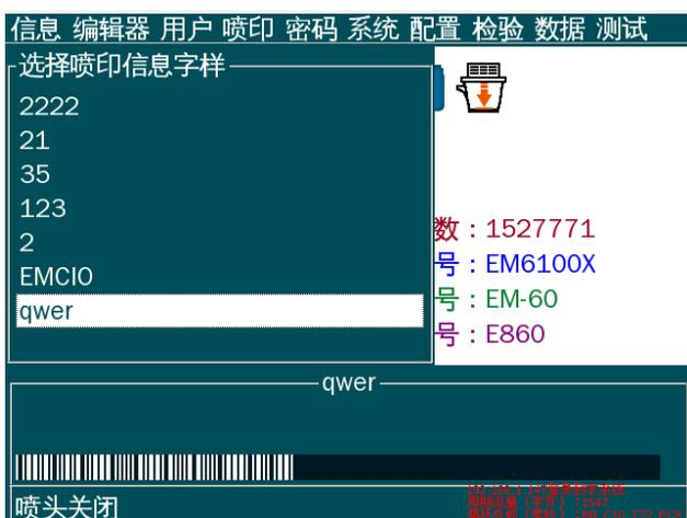
(6) 按 F1 键开启墨线，显示屏出现开启墨线图标的闪动，图标停止闪动时表示喷头已打开，可以喷印，在主界面中选择【喷印】菜单→选择【喷印开启】→【enter】→弹出对话框喷印，按【
