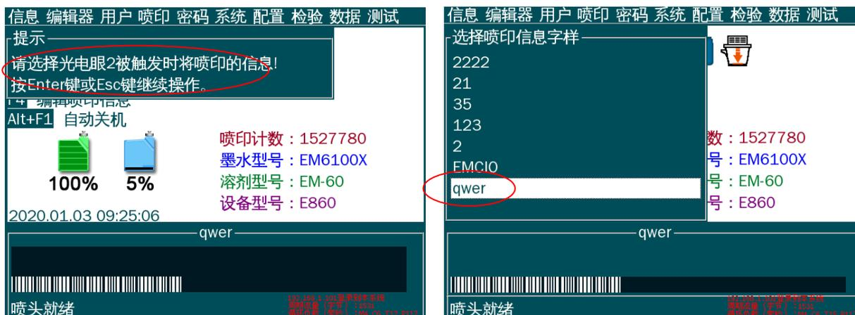
(3) 在【自动重复喷印】栏选择【启用】--按【Enter】键，【自动重复喷印】信息中会出现【重复次数】栏，可以对信息进行更正，选择自己需要的数据。按【Enter】键，开始喷印按操作说明书第七部分第一小节第6步操作喷印即可。
